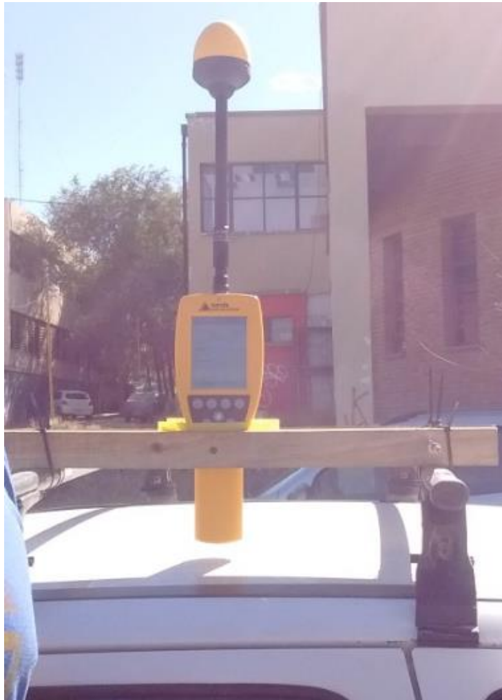
Figura 3: Colocación del Sensor Narda en el vehículo
