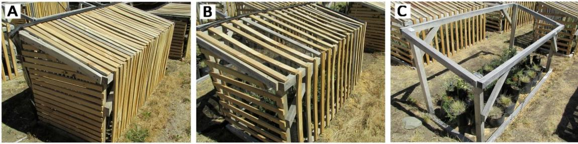
Figura 3.1 Estructuras para los tratamientos de irradiancia baja (A), media (B) y alta (C).
