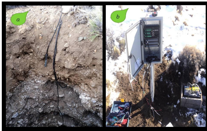
Figura 2.5 a) Instalación de sondas ECH20 (Decagon Devices, Inc.) a 10, 50, 100 y 200 cm de profundidad, b) sondas conectadas a un sistema automático de adquisición de datos (CR1000, Campbell Scientific).
