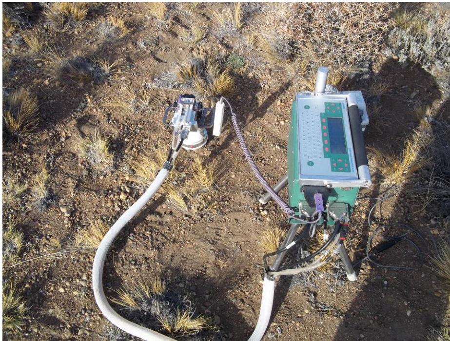
Figura 4.1 Sistema de intercambio de gases (Li-Cor 6400) con una cámara de respiración de suelo (Li-Cor 109).
