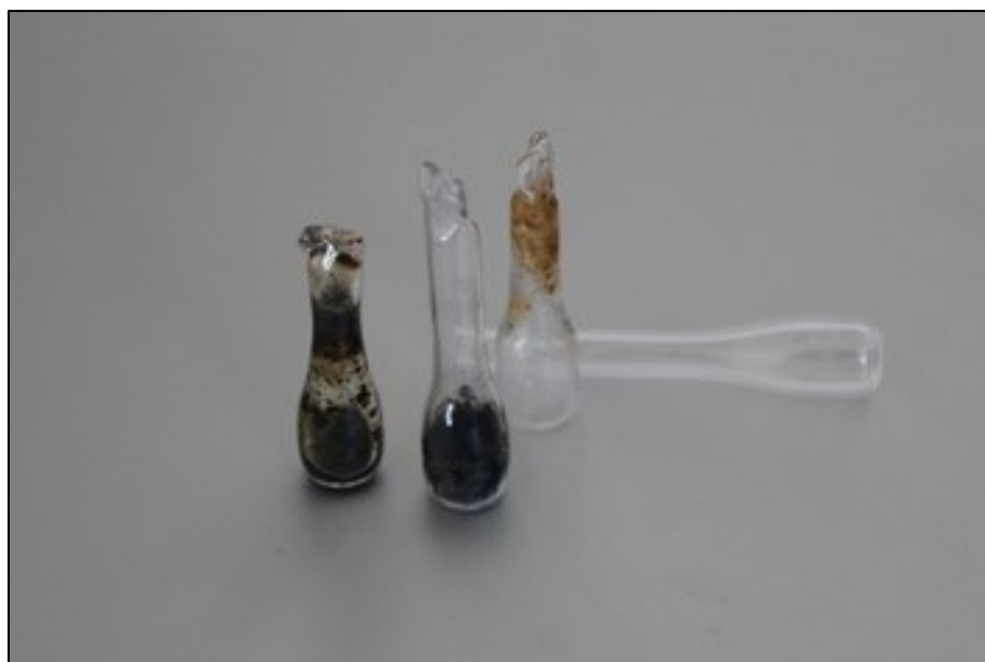
Figura 5.4: Detalle de las ampollas de cuarzo selladas con las muestras.
