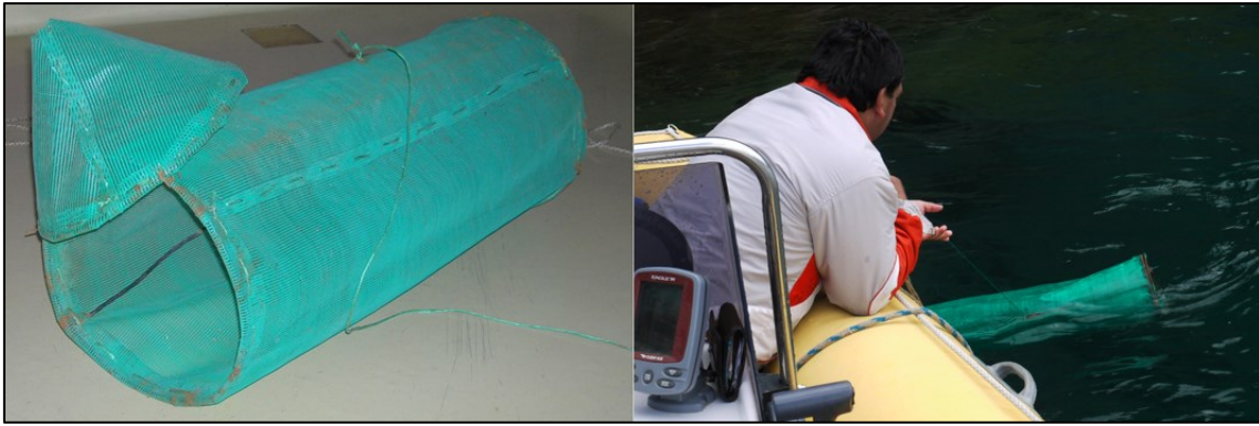
Figura 2.5: Cilindro utilizado para coleccionar macroinvertebrados bentónicos, Galaxias maculatus y juveniles de salmónidos.
