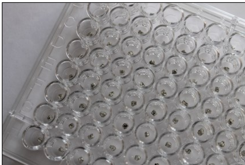
Figura 2.8: Cápsulas de estaño preparadas para AIE.
