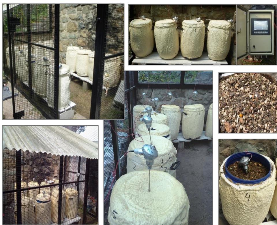
**Figura 3.4.** Sitio de instalación del ensayo (izquierda arriba y abajo); reactores con lanzas de sensor de temperatura y PLC (derecha arriba); mezcla y reactor con monitoreo automático de temperatura (derecha abajo); y ensayo instalado (centro).
