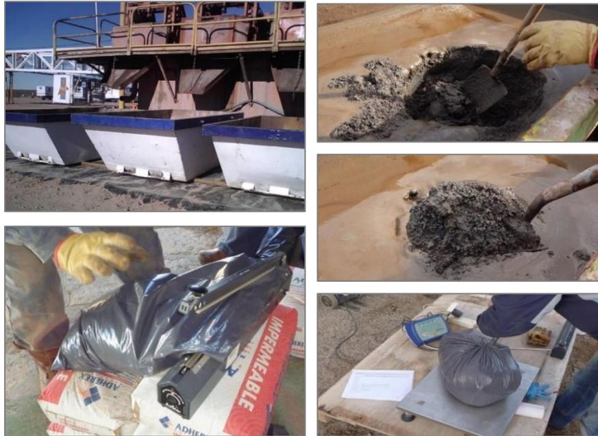
**Figura 3.1.** Recolección de recortes de perforación base oleosa en locación: lengüetas de salida de separador a contenedores (izquierda arriba), colección desde contenedores y pesaje (derecha), y termosellado de bolsas (izquierda abajo).
