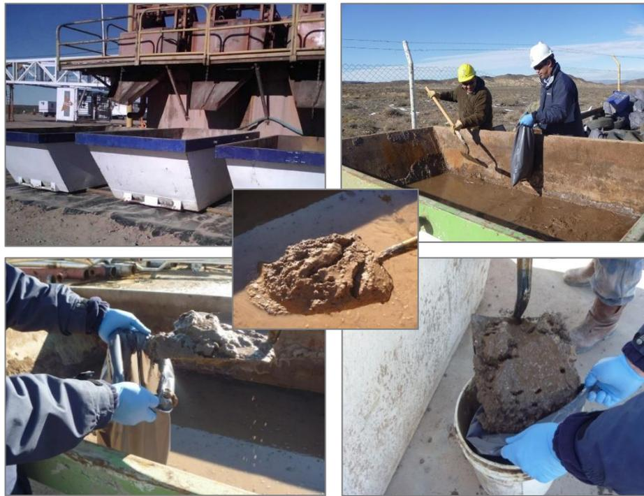
**Figura 2.1.** Recolección y envasado de recortes de perforación base agua en locación.
