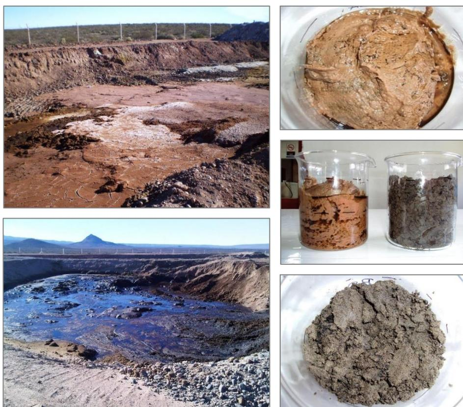
**Figura 1.2.** Recortes de perforación en repositorio en campo y vista cercana de muestras: recorte base agua (arriba) y recorte base oleosa (abajo).
