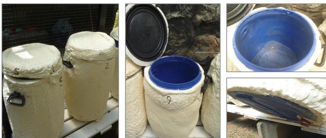
**Figura 3.3.** Reactores (60 L) utilizados en la experiencia (izquierda y centro), con falso fondo de malla metálica y sistema de desagote para la separación y colección de lixiviados (derecha).
