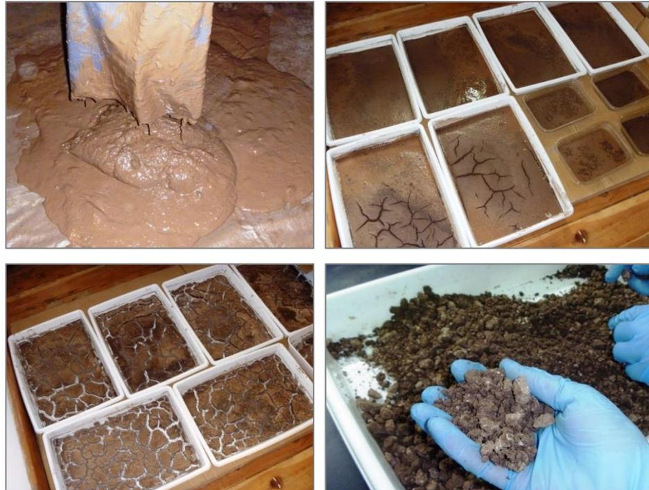
**Figura 2.2.** Aspecto recorte de perforación base agua fresco (izquierda arriba); secado en bandejas y aspecto luego del secado (derecha abajo). Nótese la textura predominantemente arcillosa y los cristales de sales en el recorte base agua.
