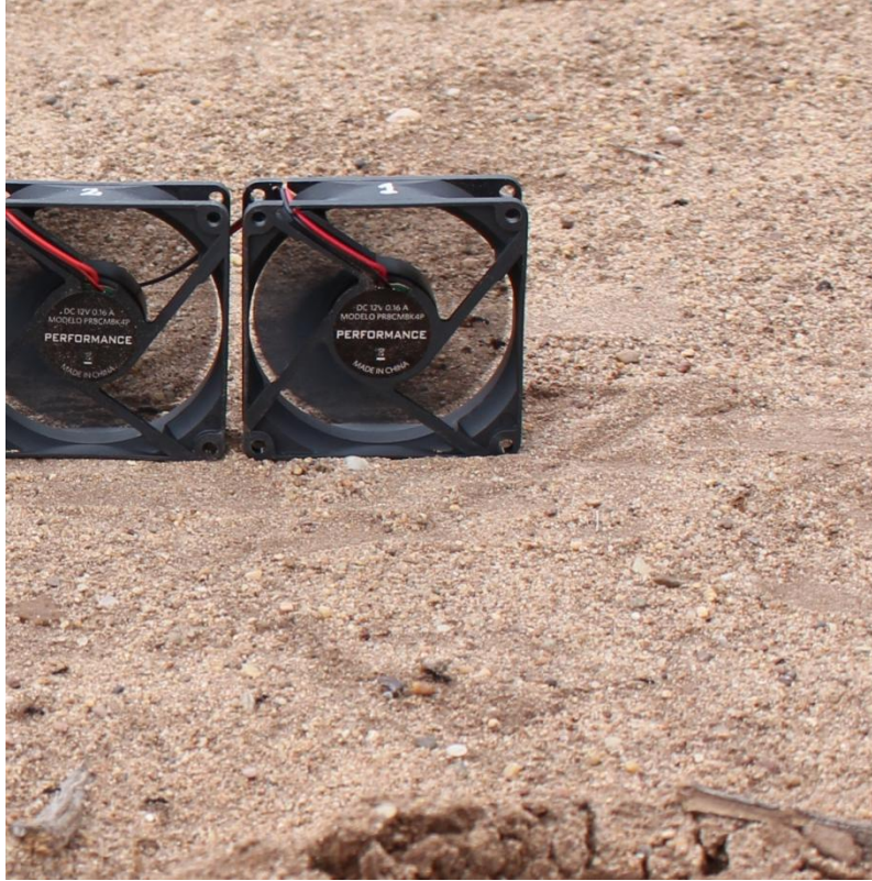
Figura 2.1.2. Experimento para evaluar el efecto del viento utilizando ventiladores de PC. En cada sendero filmé 10 cm expuestos al viento y 10 cm no expuestos. Los ventiladores fueron colocados a 5 cm del sendero.
