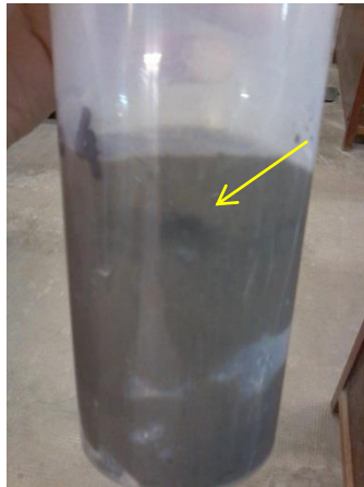
Figura 7.2. Fotografía de una muestra de sedimento donde se observa una región ennegrecida que se atribuye a la presencia de sulfuro de hierro (II).
