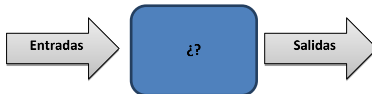
Figura 5.1. Esquema que representa un sistema considerándolo una caja negra. Sólo se estudian las entradas y salidas del sistema sin describir en detalle en los procesos que ocurren en él.
