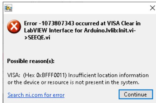
*Figura A3.6: Error 107380743 producto de una desconexión del cable USB de la placa Arduino proveniente del programa Labview.*
