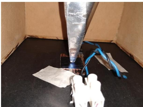
*Figura A3.10: Posicionamiento de una celda de en el interior del gabinete respecto del concentrador.*
