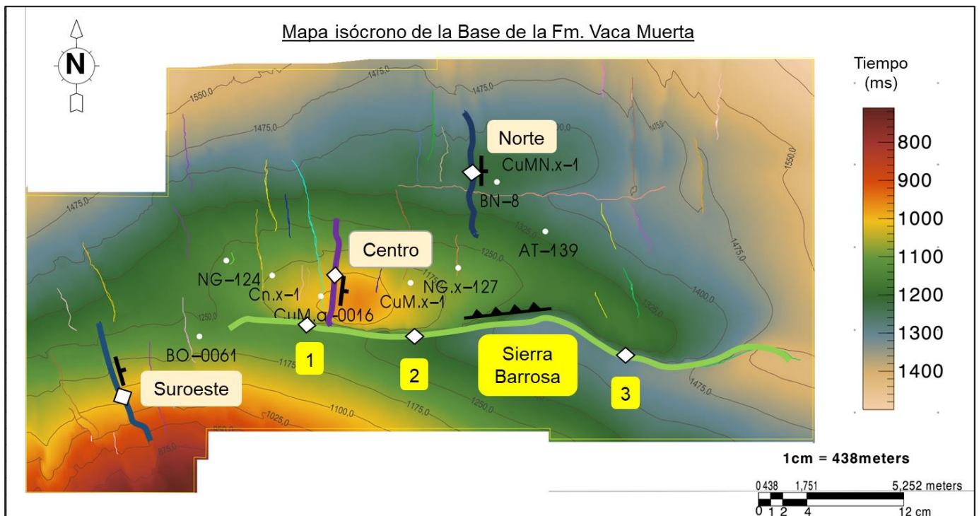
Figura 41. Mapa isócrono de la Base de la Fm. Vaca Muerta, muestra los puntos de medición del rechazo vertical den 3 fallas normales/directas (Norte, Centro, Sureste) y falla inversa (1, 2 y 3). Valores en metros del rechazo ver en la tabla 7.
