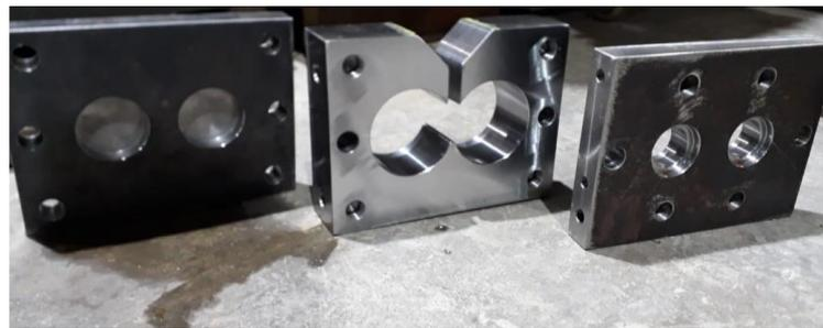
Figura 34. Cámara de mezcla - Tapas Frontal y Trasera.
