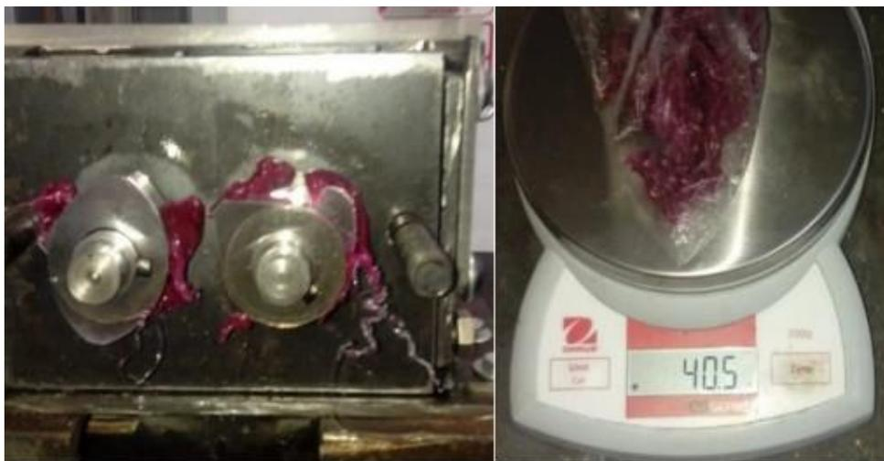
Figura 40. Muestra obtenida luego de procesar una mezcla de Polipropileno y *Remafin Rosa PE 0330*.
