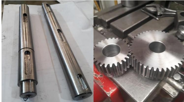
Figura 36. Ejes y Engranajes de transmisión.
