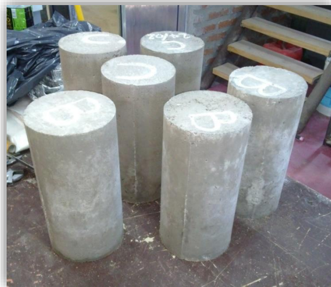
Figura 4.7 – Probetas elaboradas, dosificaciones A, B y C.
