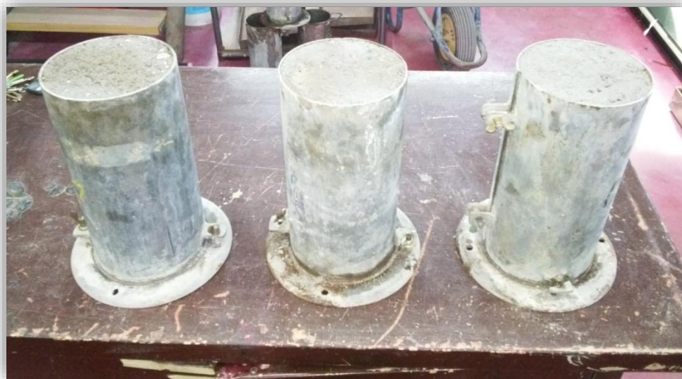
Figura 4.5 – Probetas de 15 cm de diámetro por 30 cm de alto
