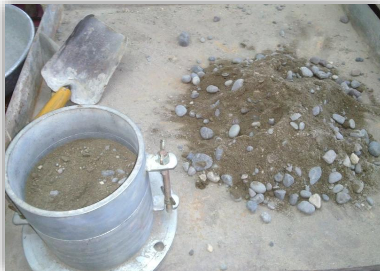
Figura 4.2 - Llenado del Molde para ensayo Proctor
