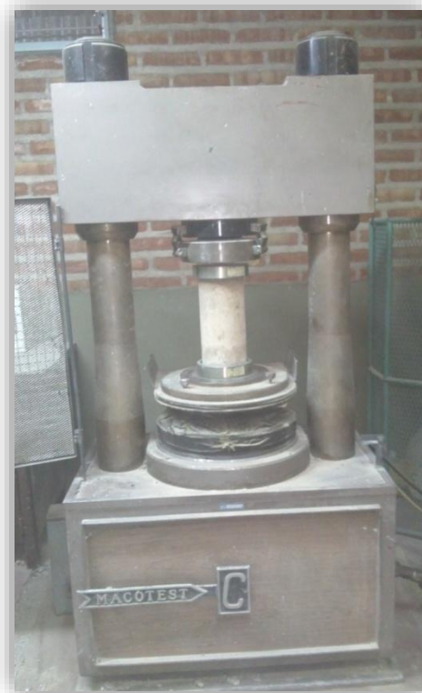
Figura 4.8 – Prensa para ensayo de rotura por compresión directa.
