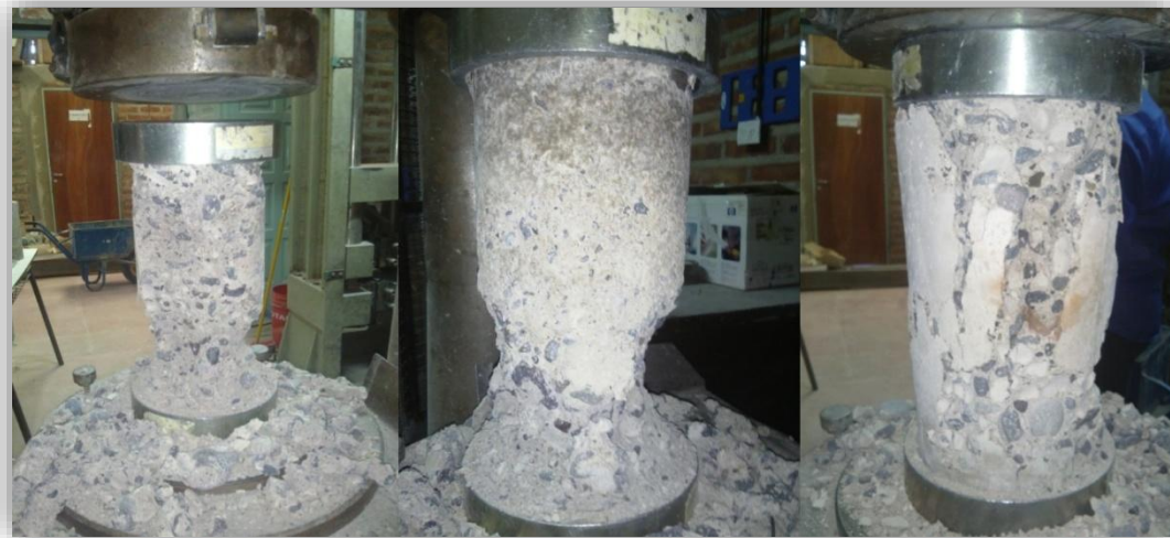
Figura 4.9 – Rotura de Probetas con dosificaciones A, B y C respectivamente.
