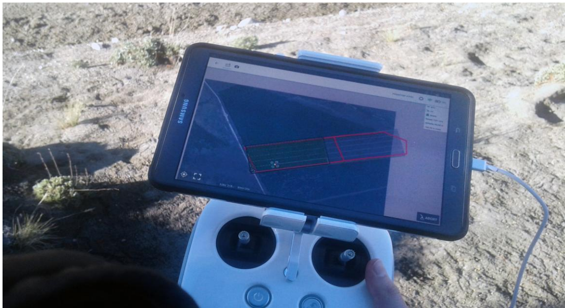
Imagen 3. Seguimiento del vuelo mediante el mapa en la tableta (autor Maciel S.)
