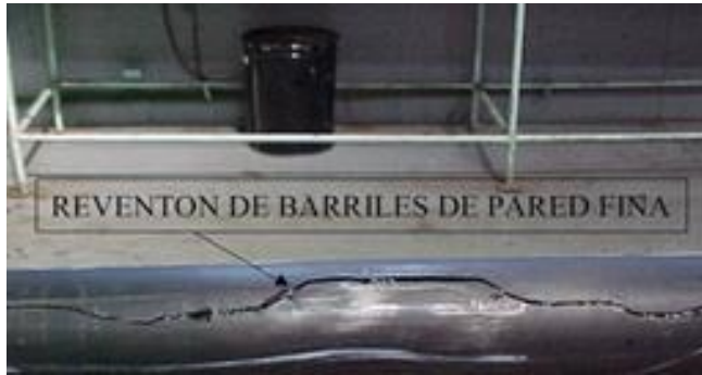
Figura 2.5: Reventón en barril de bomba (2) .
