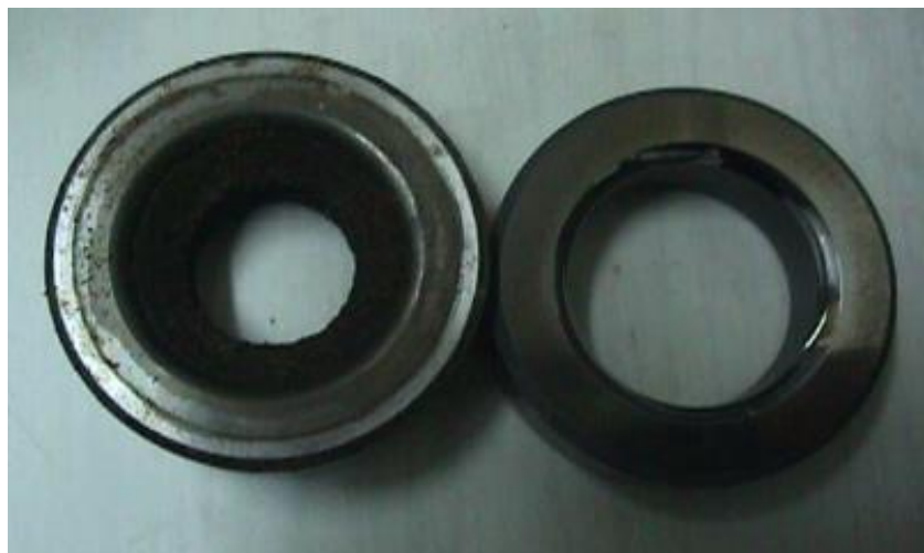
Figura 2.48: Asiento de válvula de pie con disminución de área de pasaje por formación de incrustaciones y asiento nuevo (2) .
