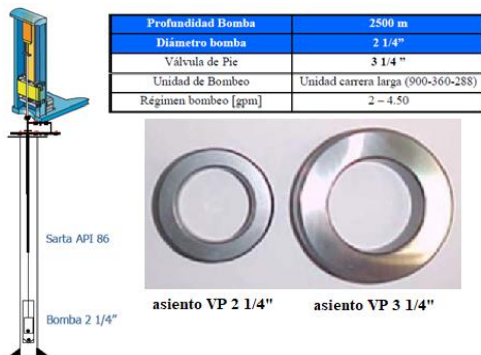
Figura 2. 39: Característica del diseño. Asiento de 2 ¼” y 3 ¼” (9) .
