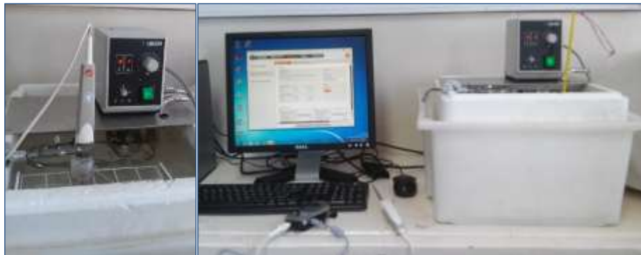
Figura 2.14. Equipamiento utilizado para determinación de las curvas de enfriamiento.
