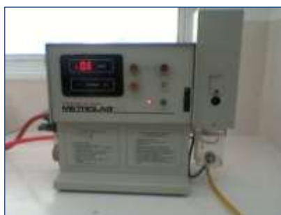
Figura 3.5: Fotómetro de llama utilizado para la medición de \text{Na}^+ y \text{K}^+ .
