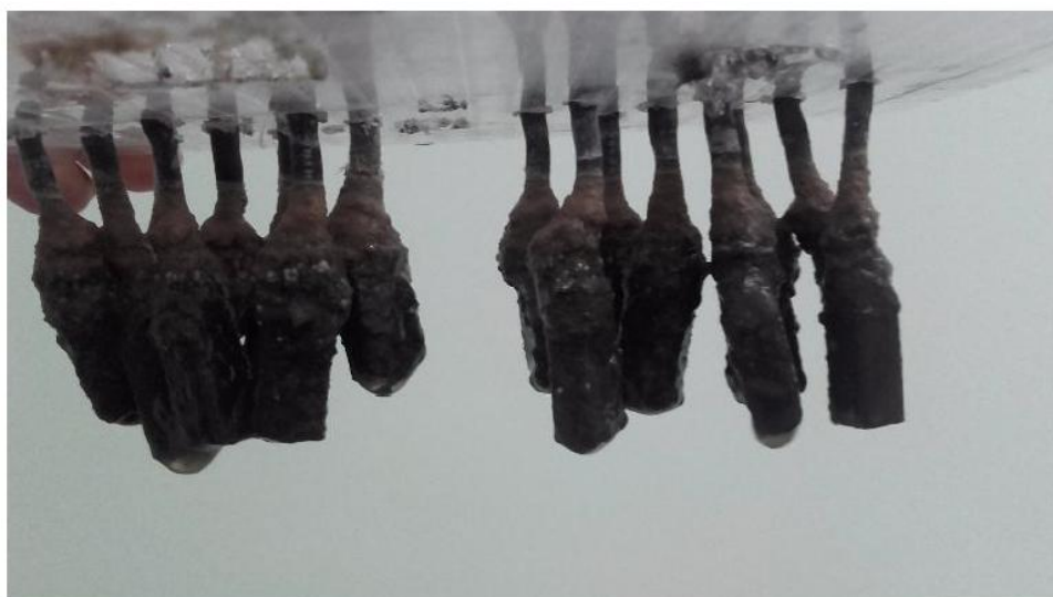
Figura 5-1: Biopelícula formada en el ánodo durante la puesta en marcha.
