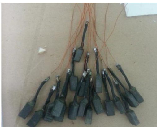
Figura 4-3: Electrodos de grafito unidos al alambre de cobre.
